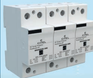
DS253VG-300 ogranicznik kombinowany; typ 1+2+3; do ochrony urządzeń w szafach oświetlenia ulicznego
